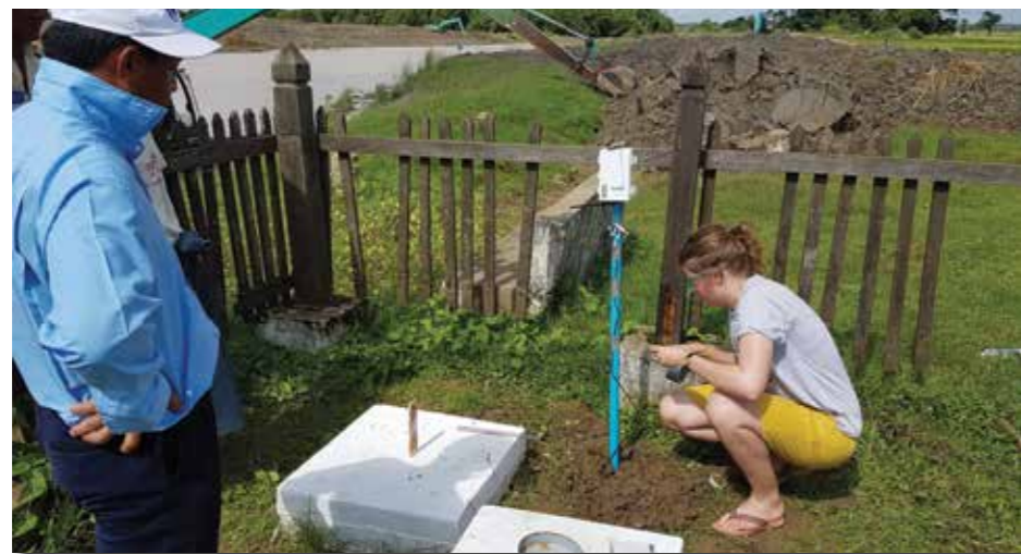
Fig. 9 Monitorizarea solului de către VanderSat în Myanmar; măsurătorile la sol sprijină și îmbunătățesc datele din satelit. 52
